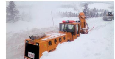
掻きだした雪をロータリ除雪車のオーガ(写真2:前方にある赤い部分)で雪を取り込み、シュート(写真2:オーガの上にある筒)で雪を飛ばして雪版面を下げていきます。この作業が「雪版下げ」です。
