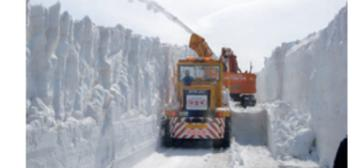
ロータリ除雪車(写真2:手前の機械)で拡幅を行った後、除雪ドーザ(写真2:奥の機械)で路面の凹凸やわだちを削って路面を平らにする作業を行います。
